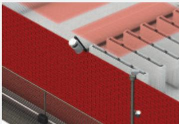
Защита крыши может быть организована извне, при помощи извещателей и видеокамер, либо изнутри здания, путем создания «виртуального» потолка. Несмотря на то, что последний способ позволяет выявить нарушителя позднее, он может оказаться более предпочтительным, поскольку установленная внутри здания система не подвергается воздействию неблагоприятных погодных условий и защищена от животных.
