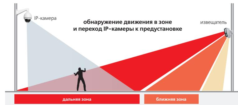
Для визуального контроля могут быть использованы поворотные IP-камеры EVIDENCE серии APIX SpeedDome, подключаемые к охранным извещателям. Камеры могут оснащаться как стандартным UTP входом, так и оптическим портом для прямого подключения оптоволоконной линии, что позволяет располагать их на любом удаленном участке без применения дополнительного оборудования.
