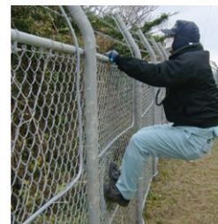
Первая линия защиты ЦОД – это его периметр. Стены и ограждения являются сильным сдерживающим фактором, но все же они преодолимы. Злоумышленник может перерезать сетку или перелезть через ограждение, а возможно, и перепрыгнуть через него, используя вспомогательные средства или расположенные рядом строения.
